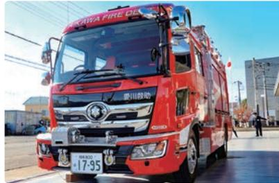
人命救助活動の充実を図るため、油圧クレーン、車両ウインチ、照明などの救助装置を搭載した救助工作車を更新しました。
